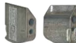
DISPOSITIVO DE BLOQUEIO PROTENSILE Para início da linha e cantos em cercados permanentes. Para arames lisos de Ø 1.8 a 2.5 mm Blister-10 ref. 676.300
